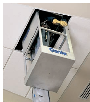
L'option panier étroit est idéale pour accéder aux faux-plafonds.
