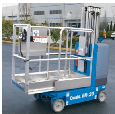
Panier doté d'une extension avec entrée à guillotine 140 x 75 cm Offre une portée horizontale de 51 cm et une zone de travail plus grande dans le panier.
