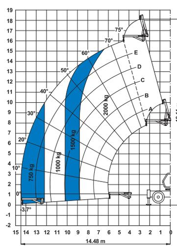
Sur stabilisateurs avec fléchette 4m (hydraulique/mécanique)
